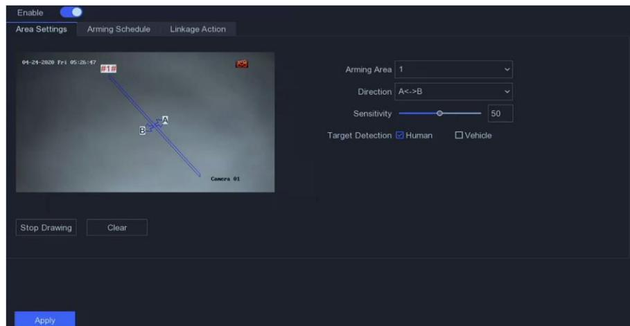
図 5-12 ラインクロッシング検知
