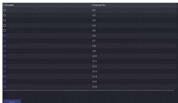
図 6-17 PoEバインディングの設定
